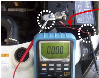
如图示串联连接万用表
